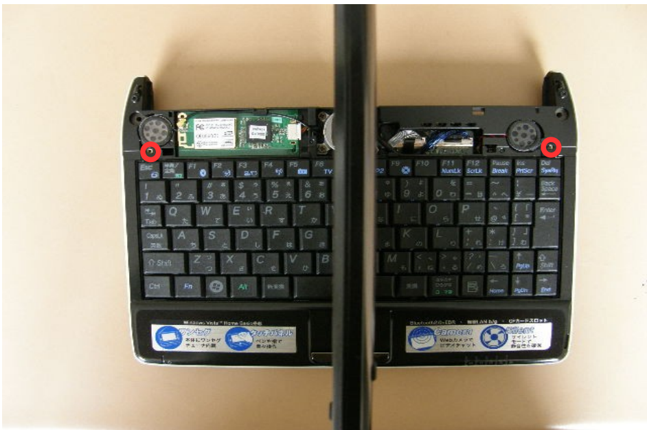
ヒンジ部分のカバーを外したら。キーボードを止めてるネジを外す(2カ所)
