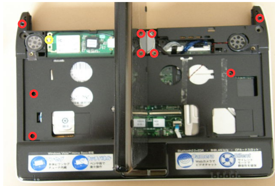
赤丸部分のネジを外して本体のカバーを外す。液晶を止めているネジを外すときは液晶が倒れないように注意。 黄丸部分の無線LANアンテナも外しておく。
